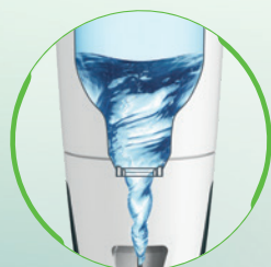
Grünbeck-Vortex-teknologi til filterrensning uden restpartikler.
